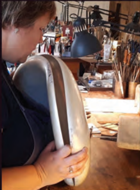
2: Efter skitsering og modellering nåede jeg frem til formen på et stort dåbsfad. Dåbsfadet er venligt, afrundet og imødekommende, og det vil skinne og reflektere omgivelserne som en dråbe dug på et blad, fortæller Lone. Her er hun ved at hamre fadet op. Kunsten består i at få den tynde sølvplade til at bule på den rigtige måde.
