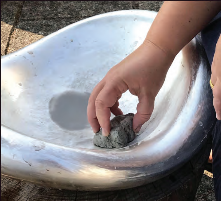
7: De værste toppe fra hammerslagene slibes i bund med en pimpsten. – Heldigvis for var det lunt i august, så jeg kunne svine med det udendørs, fortæller Lone. På billedet fornemmes fadets størrelse; det giver god mening til benævnelsen korpussølv.
