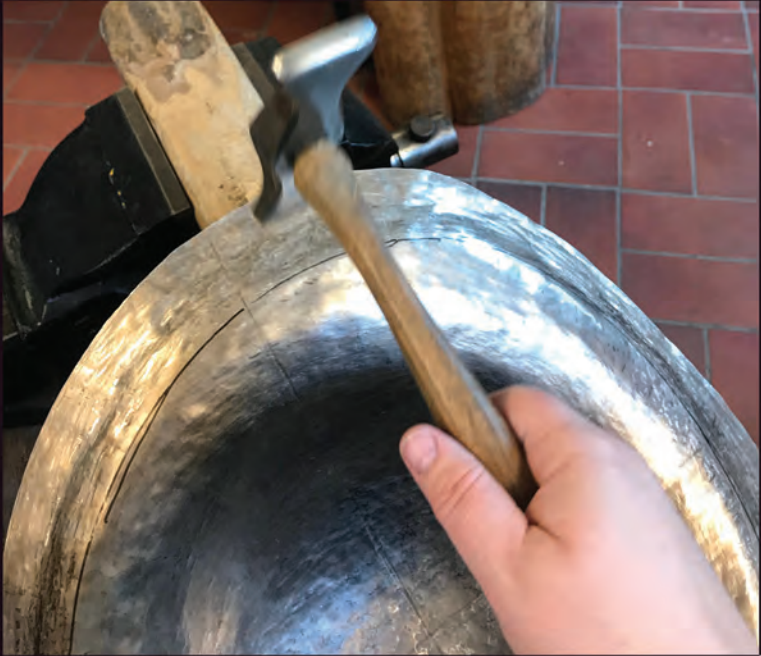
2: Efter skitsering og modellering nåede jeg frem til formen på et stort dåbsfad. Dåbsfadet er venligt, afrundet og imødekommende, og det vil skinne og reflektere omgivelserne som en dråbe dug på et blad, fortæller Lone. Her er hun ved at hamre fadet op. Kunsten består i at få den tynde sølvplade til at bule på den rigtige måde.
