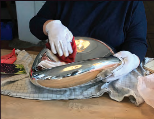
8: Sidste finish er naturligvis at tørre efter med den blødeste klud og undgå småridser og fedtede fingre. Forud for denne blanke overflade går en del smerglen, slib og polering.
