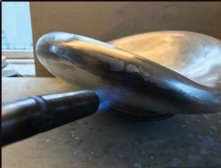
6: Loddefugen skal være usynlig, så små huller, der viser sig, når det overskydende slaglod fjernes, må loddess ud og nittes.
